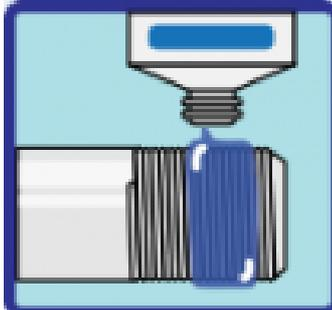
Нанести гель равномерно по всей окружности резьбы на глубину предполагаемой сборки.
