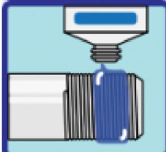
Нанести гель равномерно по всей окружности резьбы на глубину предполагаемой сборки.
